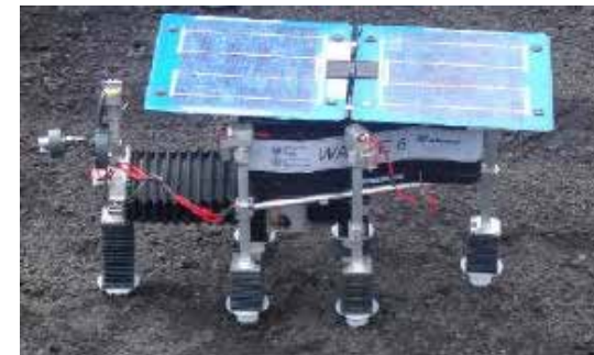
Walkie Robot tested on Mountain Etna (by Politecnico di Torino)
